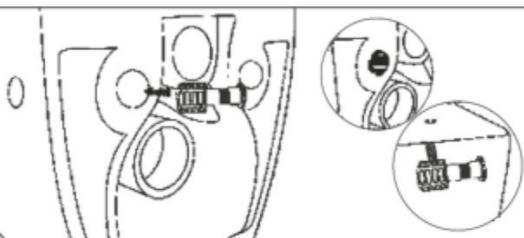
3) "Inserire le viti D all'interno dei fissaggi C. Successivamente inserire le parti C nei fori di fissaggio presenti nella parte posteriore del vaso."
